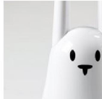
Ha un pulsante sulla testa, due orecchie mosse da motorini passo-passo e con encoder per rilevarne la posizione, 4 LED multicolori, un lettore RFID, una scheda audio con microfono ed una scheda WiFi.
